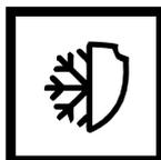
Защита от замерзания. Регулярное автоматическое включение котла при понижении температуры для предотвращения замерзания теплоносителя.
