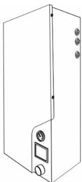
Электродкотёл преобразует электрическую энергию в тепловую посредством работы трёх электронагревателей (ТЭНов), заключённых в алюминиевый теплообменник. Движение теплоносителя в системе отопления осуществляется циркуляционным насосом.
