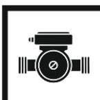
Защита насоса от закипания. Включение насоса раз в сутки для предохранения его внутренних частей от образования отложений кальция и пр.
